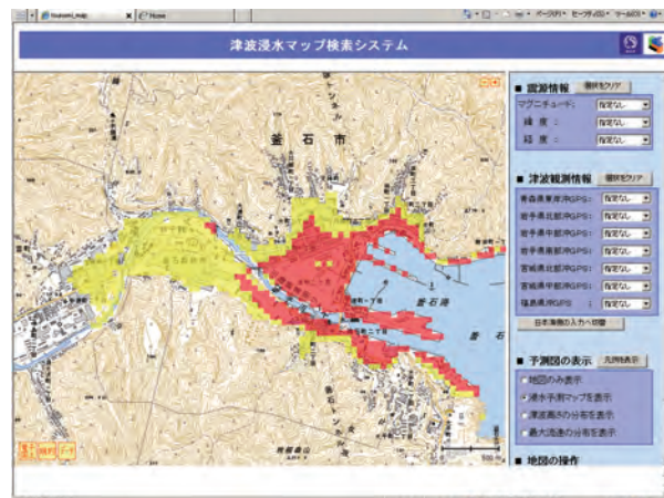
図 8 リアルタイム津波浸水予測システムの画面例
